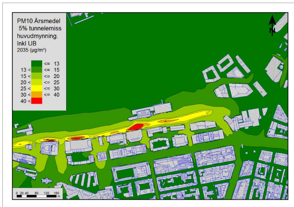
Figur 5 Beräknad total PM 10 -halt (µg/m 3 ) år 2035 för årsmedelvärdet. Röd haltgräns anger överskridanden av MKN (40 µg/m 3 ).
