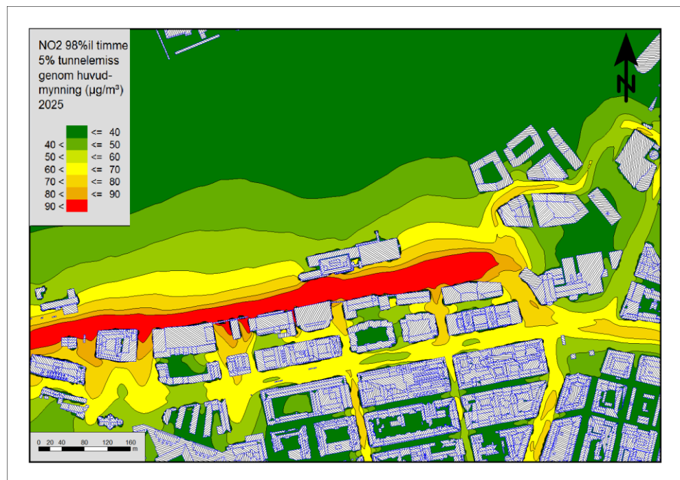
Figur 4 Beräknade NO 2 -halter (µg/m 3 ) i markplan år 2025 för 98-percentilen av timmedelvär- det. Röd haltgräns anger överskridanden av MKN (90 µg/m 3 ).
