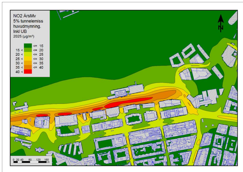
Figur 2 Beräknade NO 2 -halter (µg/m 3 ) i markplan år 2025 för årsmedelvärdet. Röd haltgräns anger överskridanden av MKN (40 µg/m 3 ).
